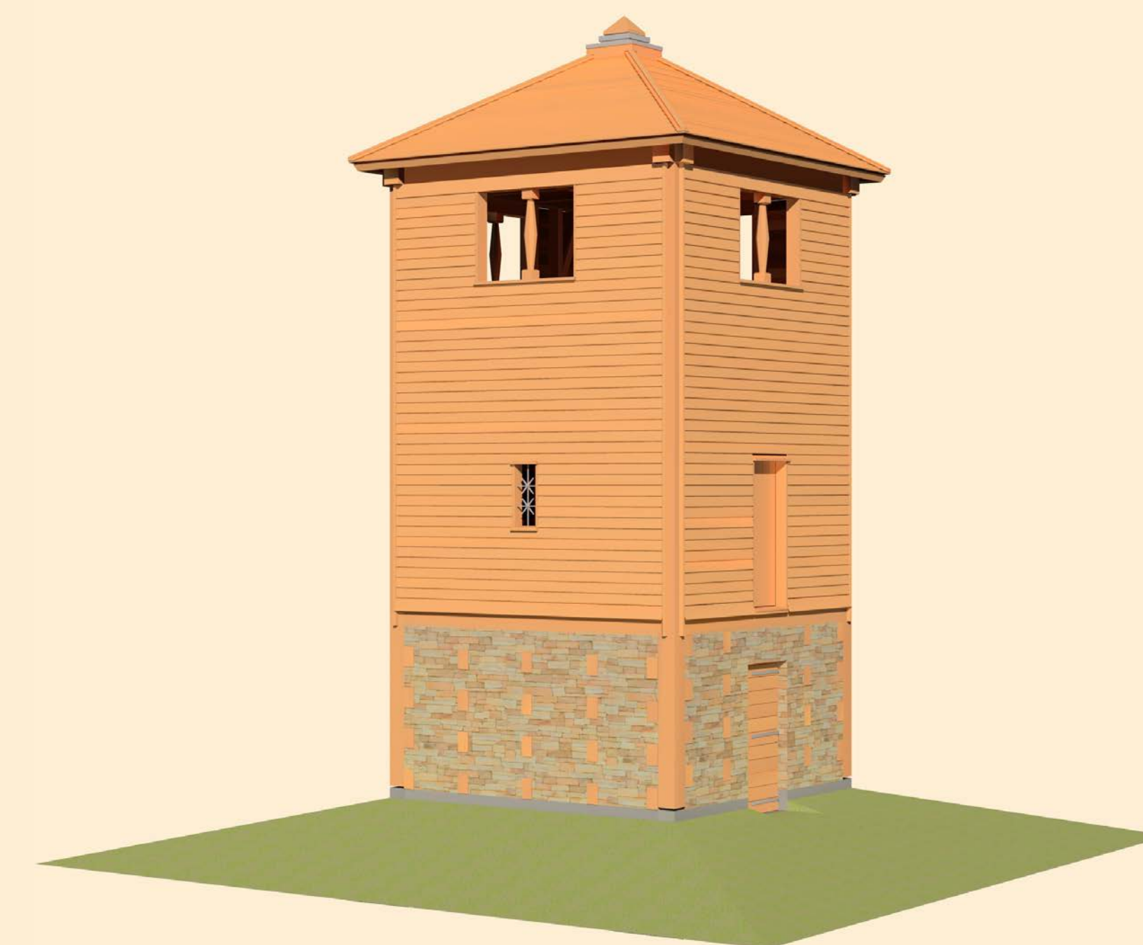
Perspektive des Turmes, die oberen Geschosse mit Stulpverschalung, das Erdgeschoss mit rotem Sandstein und durchgesteckten Eichenbalken
