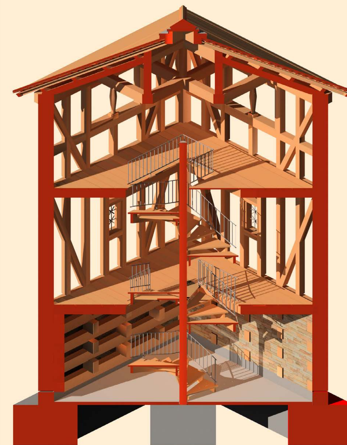
Diagonalschnitt durch den geplanten Turm, mit seinen drei Geschossen.
